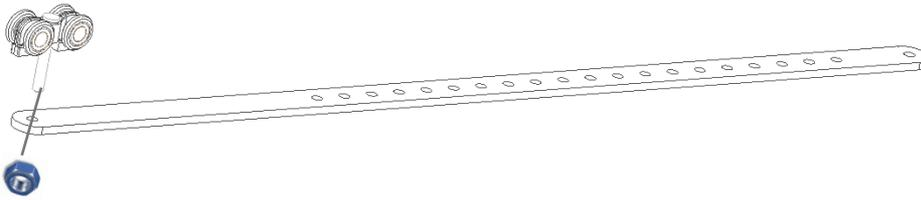
**Etape 1 :** Insérer l'ensemble bras dans le rail de refoulement
