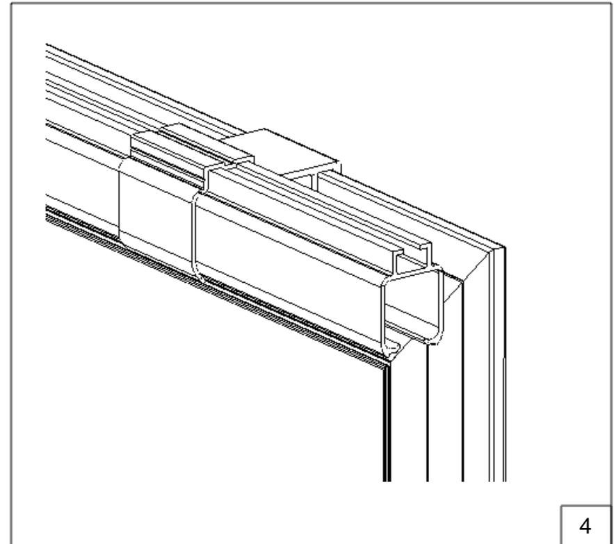
Une fois les supports rail O insérés, disposer l'ensemble sur le profilé cadre.
