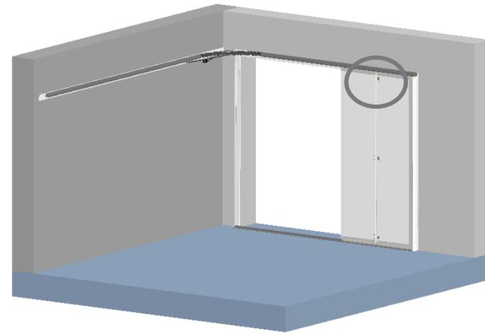
Insertion des chariots de guidage dans le rail
