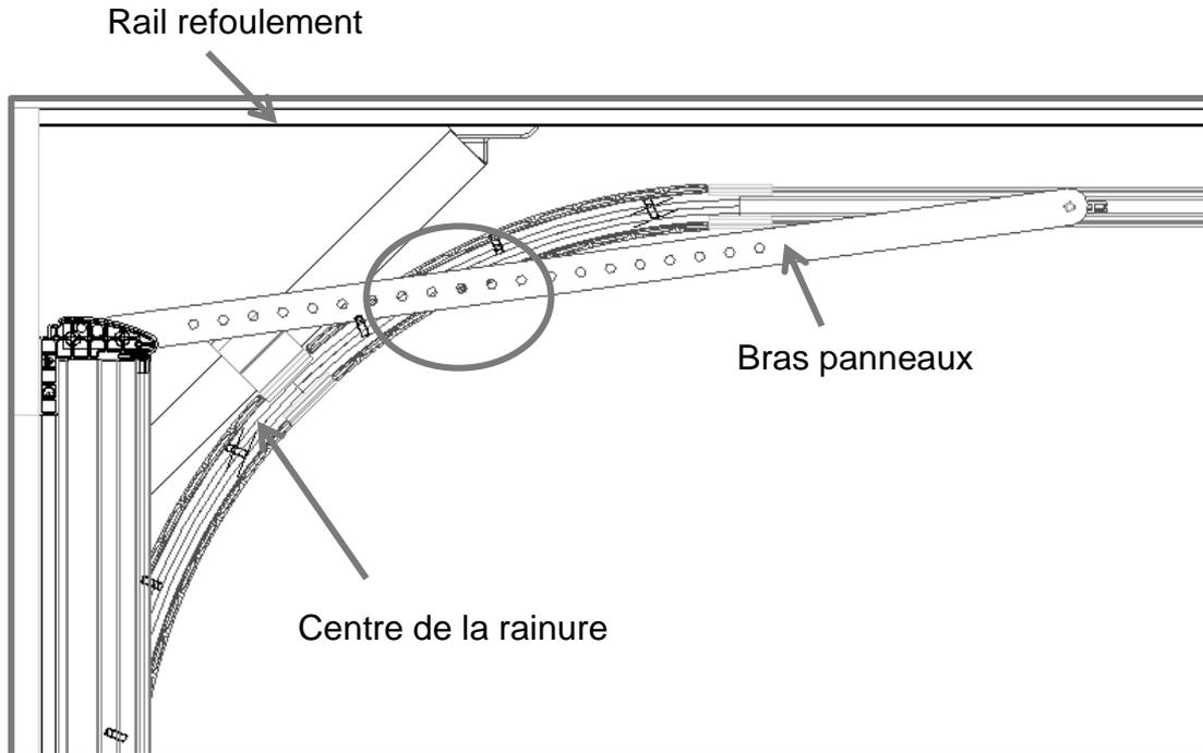
**Etape 3 :** Pour positionner le second chariot, il faut mettre la porte dans sa position fermée (en fonction de l'écoinçon et du centrage des cassettes) puis regarder par dessous et repérer le trou du bras qui tombe au centre de la rainure du cintre. (voir ci-contre).
