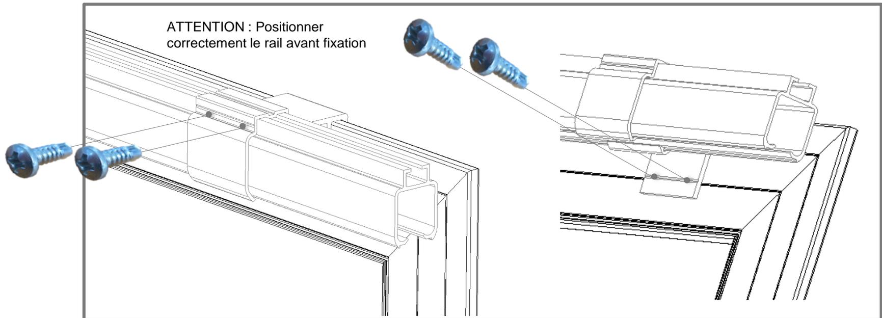
Fixer les supports rail O et R sur le profil cadre, et fixer le rail haut sur les supports rail O et R
