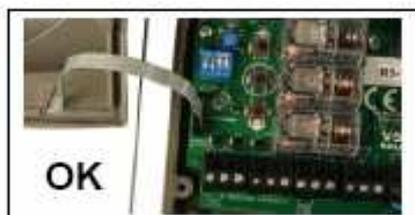
Connecter avec précaution la nappe des boutons de commande extérieurs sur le bornier sur la carte électronique et réintégrer la LED dans le couvercle en respectant les photos ci-contre.
