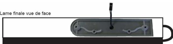
1. Le support de fixation de l'émetteur barre palpeuse est déjà fixé en usine sur la lame finale : le câble de connexion est pré câblé à travers le centre du support, en attente de branchement de l'émetteur palpeur RTS.
