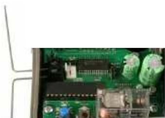
Prendre les deux antennes dans l'emballage et les visser au récepteur (cf. ci-contre pour repérer les antennes et le connecteur en haut à gauche de la carte électronique). S'assurer que les deux antennes ne se touchent pas, ne se croisent pas et qu'elles pointent dans des directions opposées (une vers le haut, une vers le bas, toutes les deux parallèles au côté du produit).
