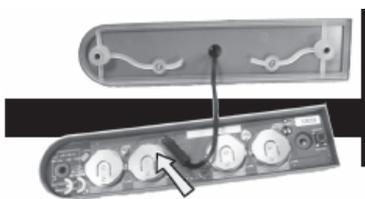
3. Une fois sorti de son emballage, présenter l'émetteur en face du support de lame finale et connecter les 2 broches du câble sur le connecteur présent à l'arrière de l'émetteur (entre les piles). Il n'y a pas d'ordre de connexion à respecter au niveau des 2 bornes.
